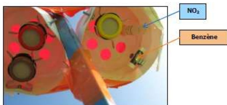
Visualisation des capteurs passifs utilisés Source : BURGEAP
